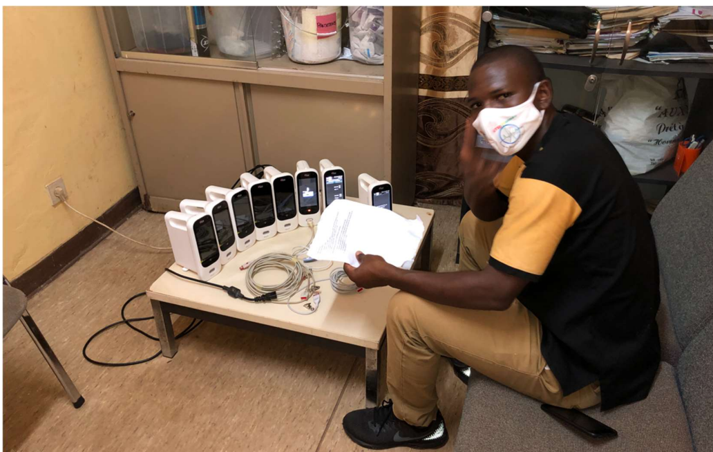
Légende : L'ingénieur biomédical de l'INSE, Monsieur Holland Barry en train d'installer la nouvelle version du logiciel aux huit saturomètres RAD-97 de Masimo, utilisés à l'INSE.
